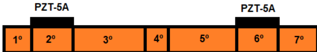
Figura 35 – Configuração da viga multicamadas com sete elementos para avaliação de danos estruturais com a cerâmica de PTZ-5A
